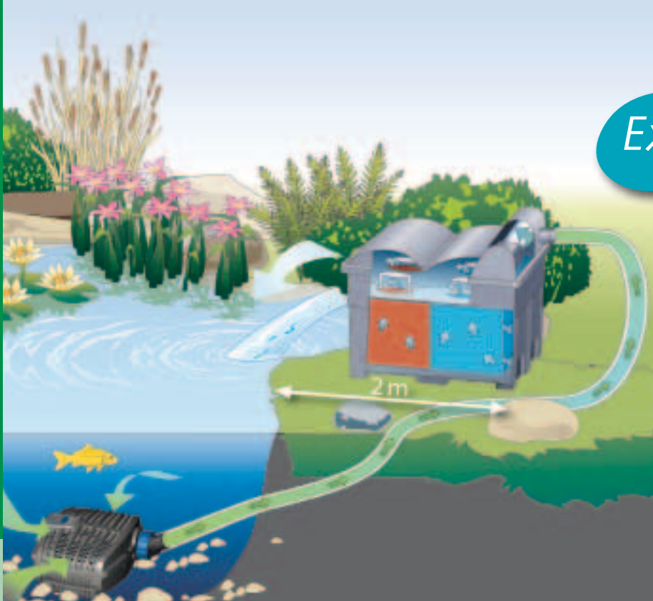
Schematische weergave: BioSmart Set componenten in functie
