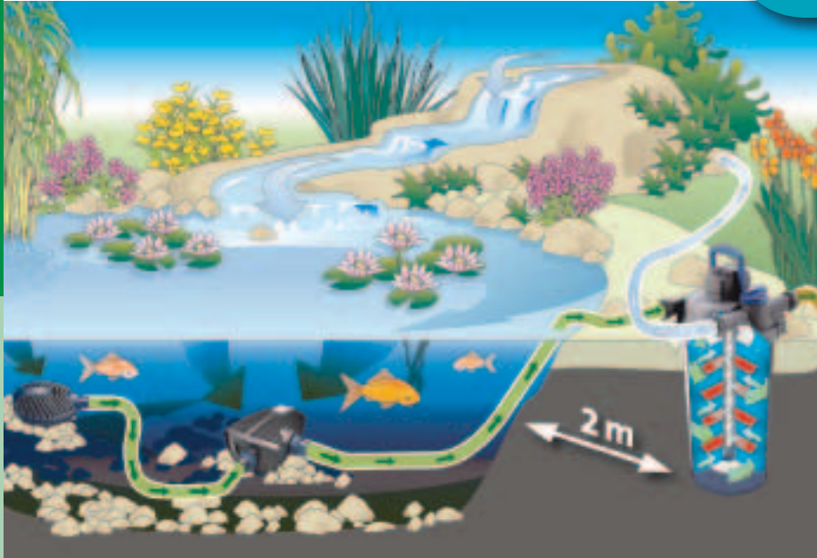
Schematische weergave: Drukfilter FiltoClear in combinatie met een filter- en beeklooppomp
