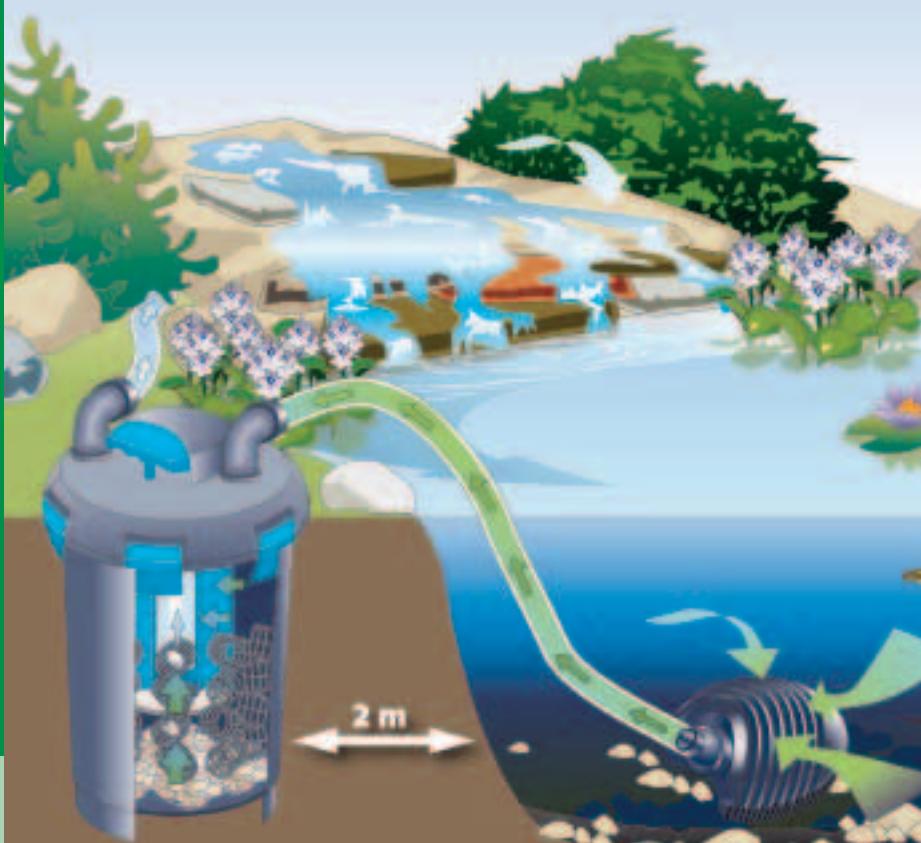
Schematische weergave: Drukfilter in combinatie met filter- en beeklooppomp
