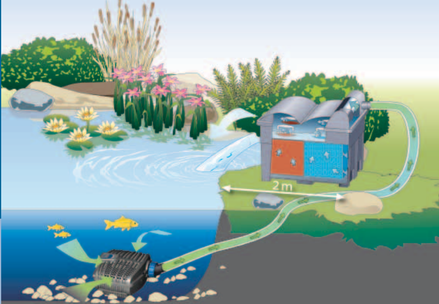
Schematische weergave: Filter- en beeklooppomp AquaMax Eco Classic (START) in combinatie met een OASE doorstroomfilter BioSmart (START)
