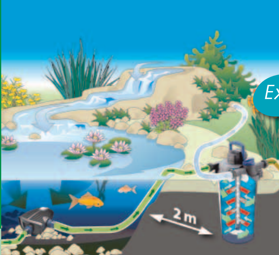
Schematische weergave: Drukfilter FiltoClear in combinatie met een filter- en beeklooppomp
