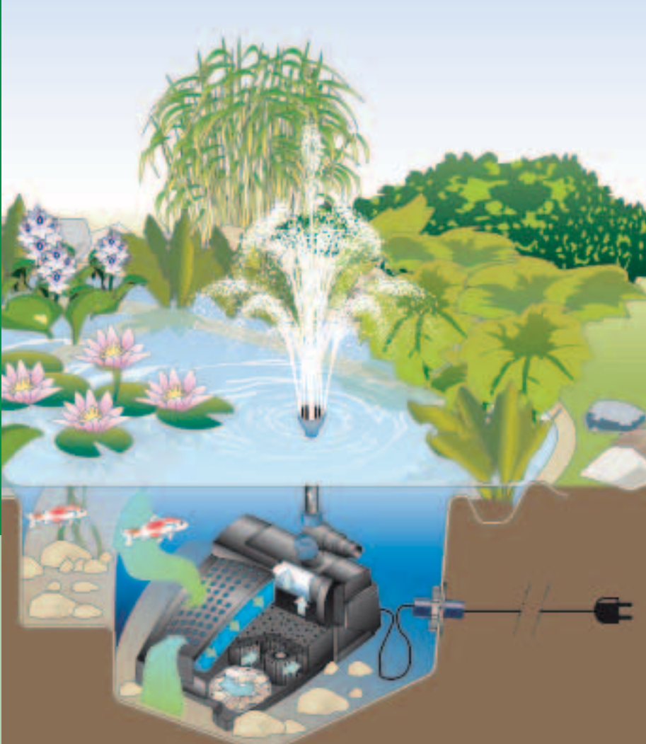
Schematische weergave: Onderwaterfilter Filtral UVC in een vijverbassin geplaatst
