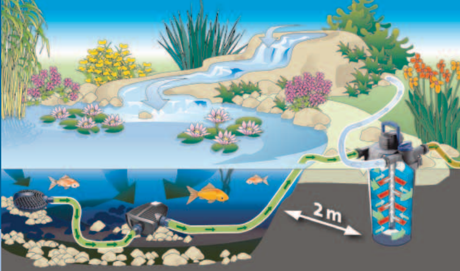
Schematische weergave: Filter- en beeklooppomp AquaMax Eco Premium (PRO) in combinatie met een OASE drukfilter FiltoClear (PRO)
