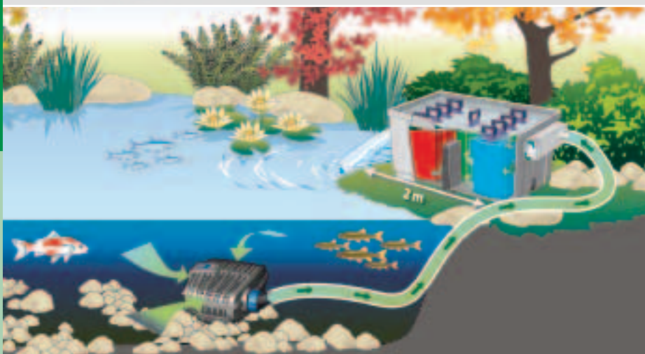
Schematische weergave: BioSmart 36000 in combinatie met de filter- en beeklooppomp AquaMax Eco Classic
