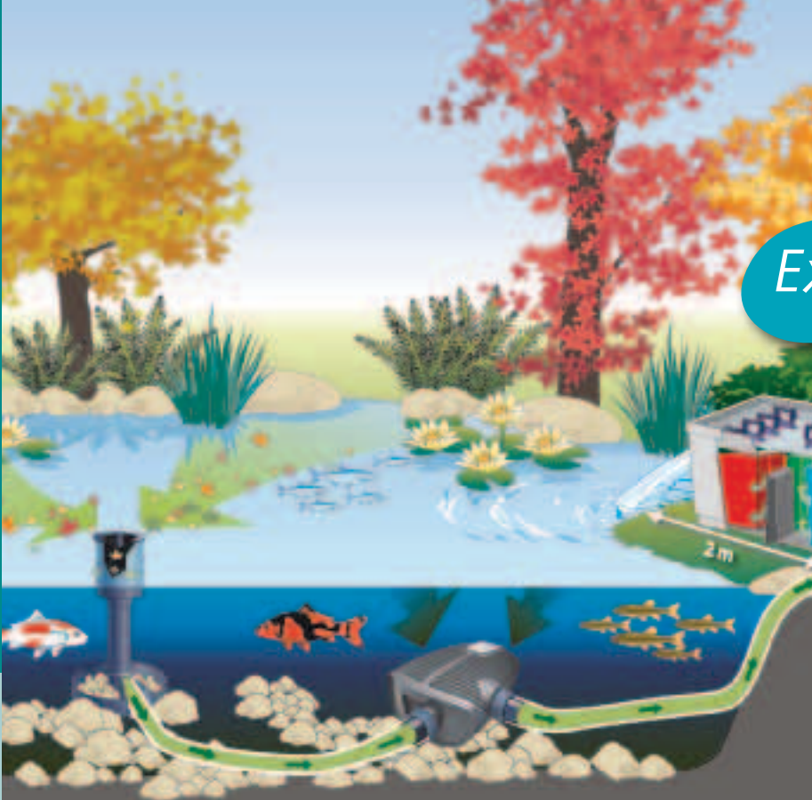
Schematische weergave: AquaSkim in gebruik met de filter- en beeklooppomp AquaMax Eco Premium
