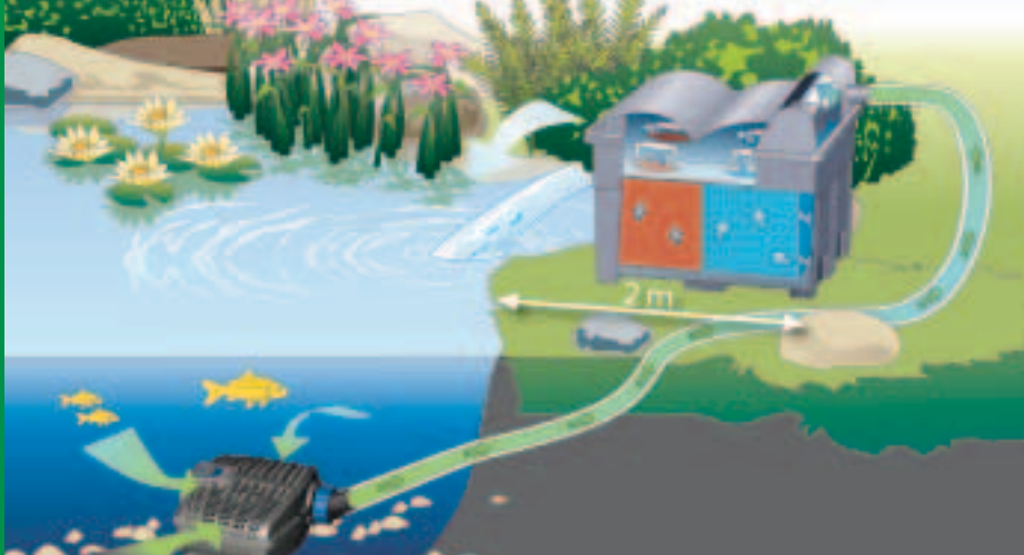
Schematische weergave: BioSmart UVC 16000 in combinatie met de filter- en beeklooppomp AquaMax Eco Classic
